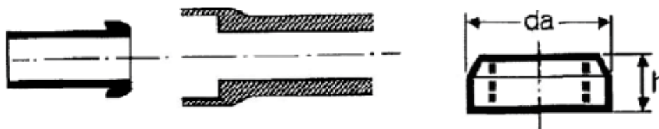
Рис.81. Перехід від чавунних до керамічних труб
