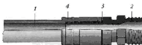
Рис.53. З'єднання натяжною латунною муфтою: 1 - Труба, 2 - Штуцер, 3 - Ущільнюоча діелектрична прокладка, 4 - Натяжна муфта
