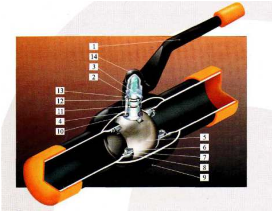
Рис.99. Конструкція та матеріали сталевого кульового крану:
