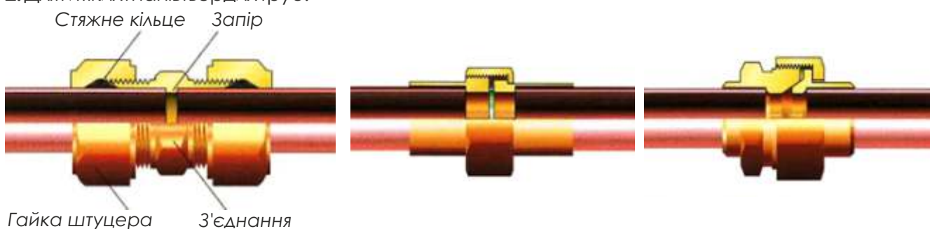
Рис. 42. Розбірні з'єднання мідних труб
