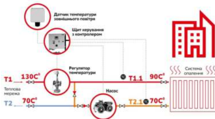
Рис. 111. Приклад встановлення регулятора температури в тепловому пункті. Система з якісним регулюванням.
