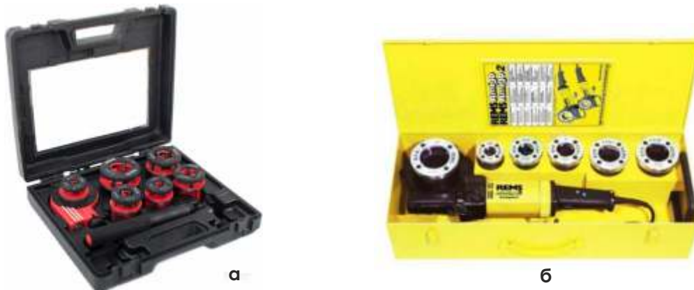
Рис.9. Трубні крупы: а – ручний; б – електричний
