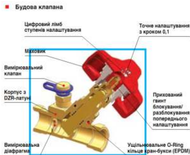
Рис.116. Будова ручного балансувального клапану.
