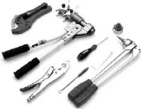
Рис.56. Інструменти для роботи з натяжними гільзами
