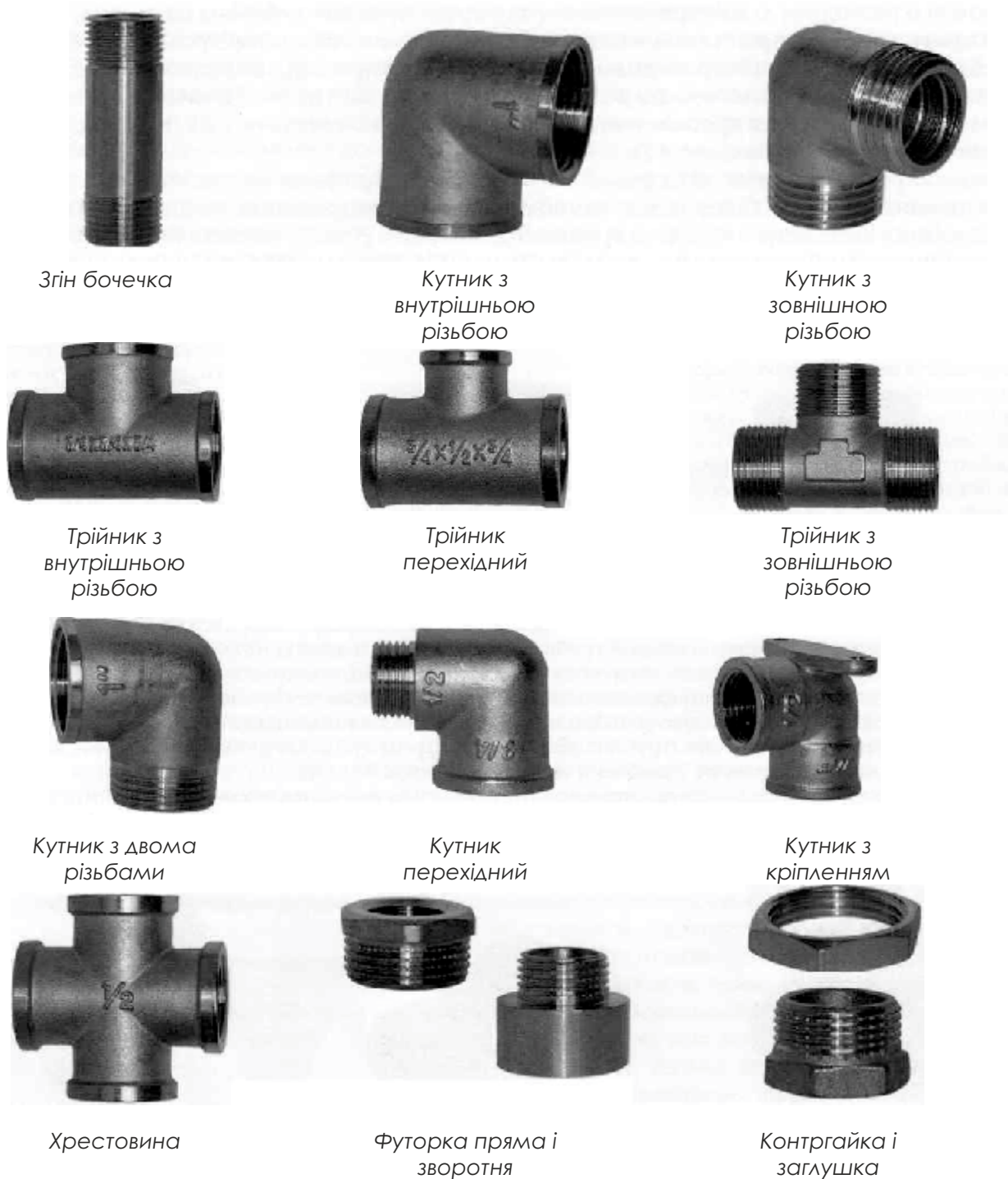
Рис.29. Фітинги для з'єднання сталевих труб
