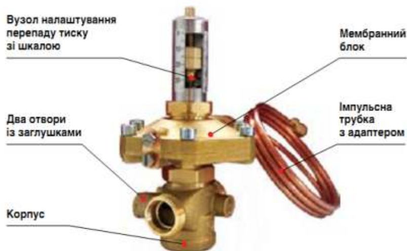
Рис. 122. Будова автоматичного регулятора перепаду тиску
